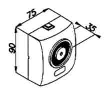
Fermi elettromagnetici fissaggio a parete
